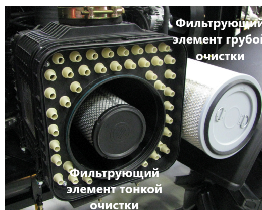
Рис. 4-5. Фильтрующие элементы воздушного фильтра (имеют отличия в зависимости от модели)
